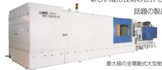
最大級の全電動式大型射出成形機
