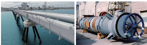
環境にやさしい「エア浮上コンベヤ」(左)と、高粘度液を連続処理する「遠心薄膜蒸発器」(右)
